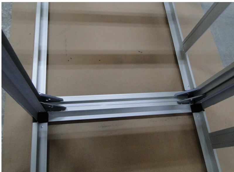
Мал.5. Приклад з'єднання секцій установок для типорозмірів вище МС8..
